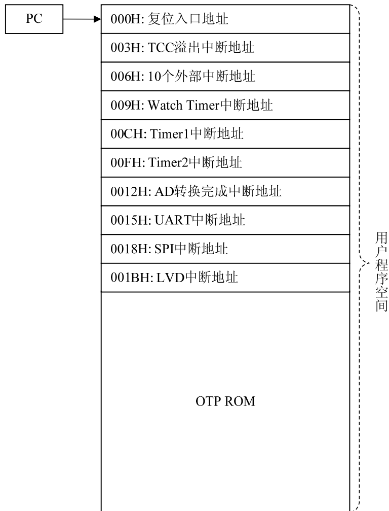
图 4.1 程序存储器结构图
